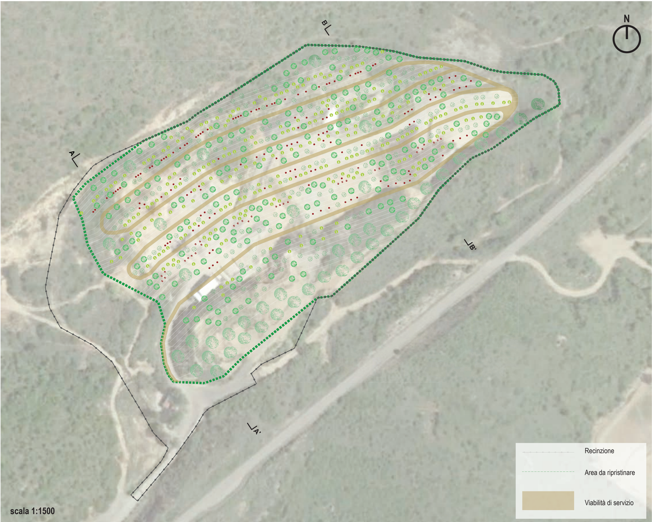
SCHEMA DI IMPIANTO Impianto a file sinusoidali con sesto a quinconce
